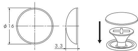
キャップとの適応を確認し、専用ワッシャーをビスでとめて、専用ワッシャーにキャップをはめます。
