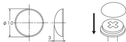
締め付けトルクを気にせずお使い頂けます。柔らかい部材でも締め付ける力加減を気にせずご使用ください。潜り込んでもキャップができます。
